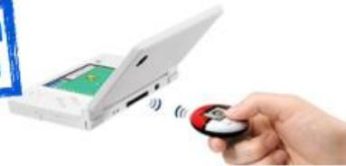
Souvent utilisée pour communiquer à courte distance (10m env.) et sans obstacle pour les télécommandes ou autres périphériques du style. Car le signal lumineux invisible (infra-rouge) n'interfère pas avec les autres signaux radios. Solution peu coûteuse !
