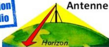
Communication longue distance par ondes Hertziennes sur plusieurs centaines ou milliers de kilomètres (satellite par exemple). Forcément plus l'émetteur du signal est haut plus le signal va loin. A Paris les émetteurs sont positionnés en haut de la tour Eiffel.
