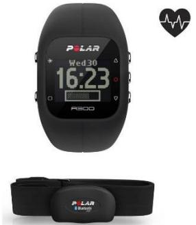
Un capteur, constitué d'électrodes et situé dans la ceinture, détecte un changement de signal électrique émis par le cœur lors d'un battement. Le comptage de ces signaux est envoyé à la montre par transmission sans fil. La montre affiche le résultat instantanément sur le cadran. La montre avertit le sportif lorsque son cœur dépasse la fréquence cardiaque maximale.
