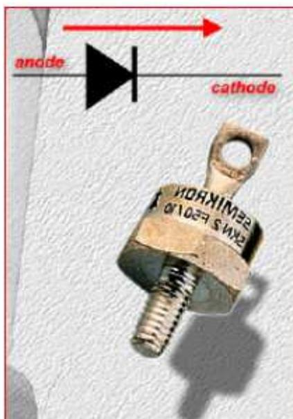
**Conclusion :** N'oubliez jamais de placer la diode anti-retour dans le circuit et dans le bon sens. Le courant passe dans le sens cathode vers anode mais pas dans l'autre. Dans le circuit de l'éolienne, le courant de charge circule du + de la génératrice vers le - de la batterie afin d'avoir un circuit en série.
